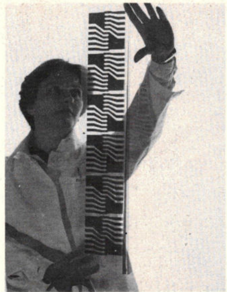
Afb. 1. Fotomasker voor 60 infrarooddetector elementen. Bij de fabricage wordt via een verkleining van 200 maal de structuur op het halfgeleidermateriaal overgebracht.
